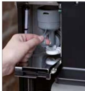
**Reinigung Mixerbecher:** Einfachste Reinigung durch einfaches Herausnehmen und Wiedereinsetzen.
